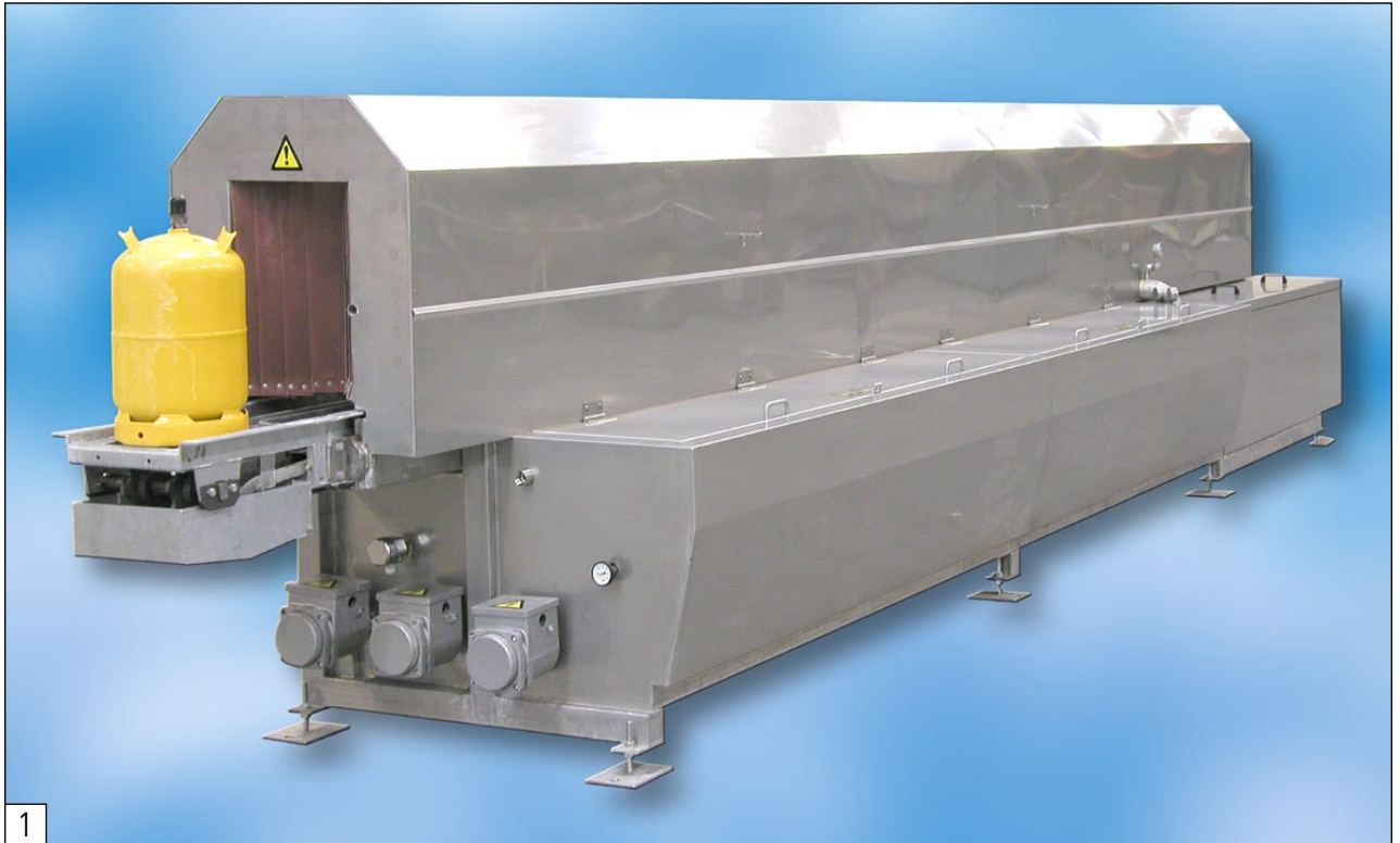
Ejemplo del sistema de lavado de Kosan Crisplant en acero inoxidable con secciones de lavado y de purga de agua
